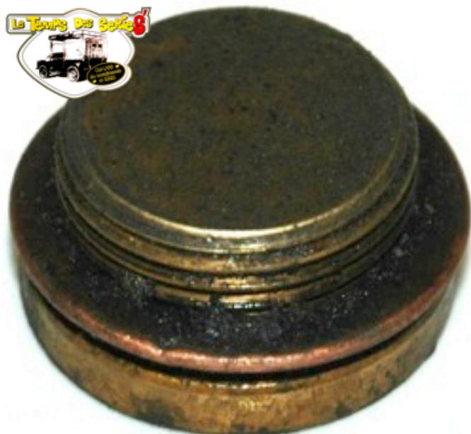
Pendant que l'huile s'écoule, changer le joint cuivre de la vis de vidange.
