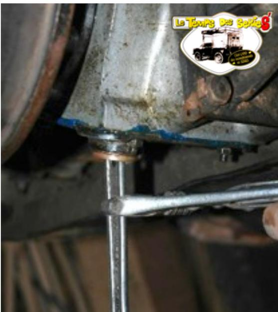
Avec une seconde clé serrant la première logée dans le trou de la vis de vidange, je peux facilement dévisser.
