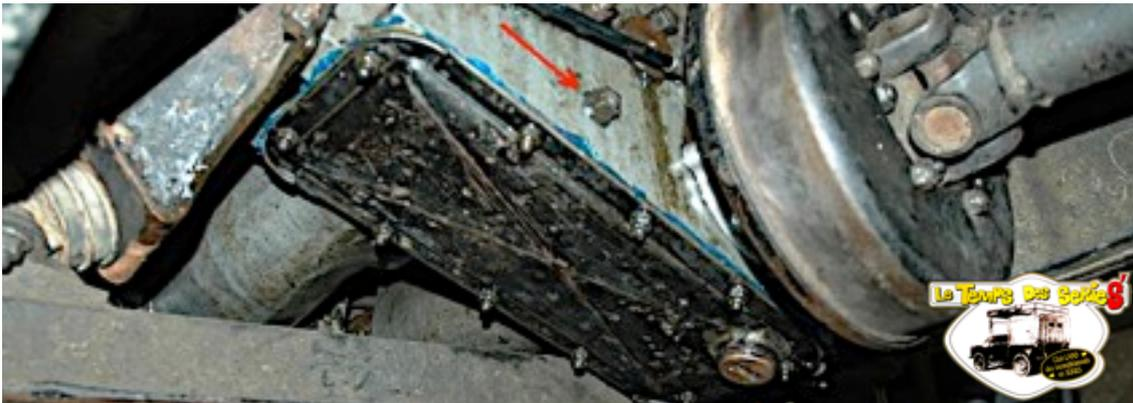
A l'aide d'une clé à molette ou d'une clé de 15mm :
